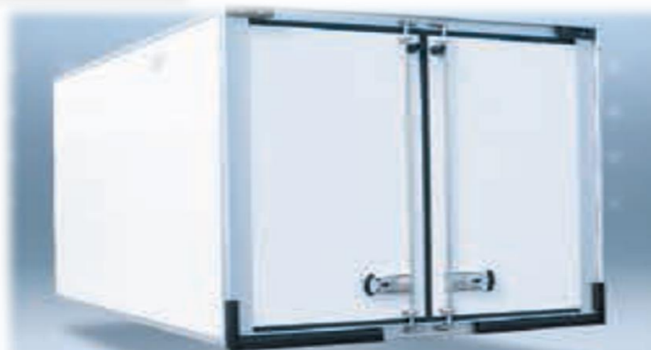
Композитні панелі (харчовий гелеобразний шар - поліефір - поліуретан), оснащені алюмінієвими вставкам
